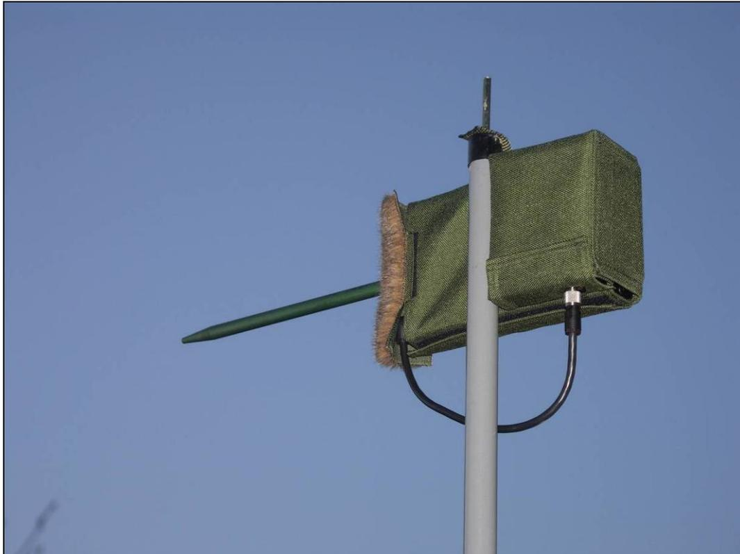
**Abb. 3** Automatische Registriereinheit („batcorder“, ecoObs, Nürnberg).
