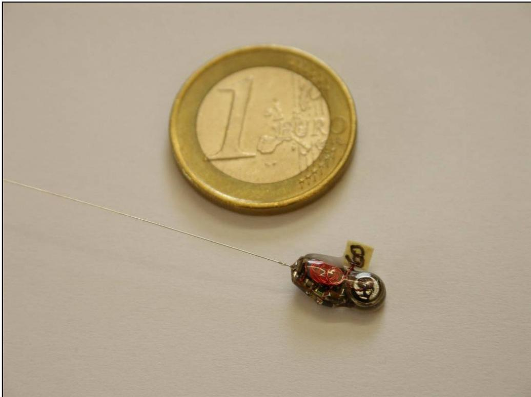
**Abb. 2** Radiotelemetrie-Sender der Firma Holohil (Modell LB-2N) mit einem Gewicht von 0,42 g für radiotelemetrische Untersuchungen von Bechsteinfledermäusen. Foto: G. Reiter
