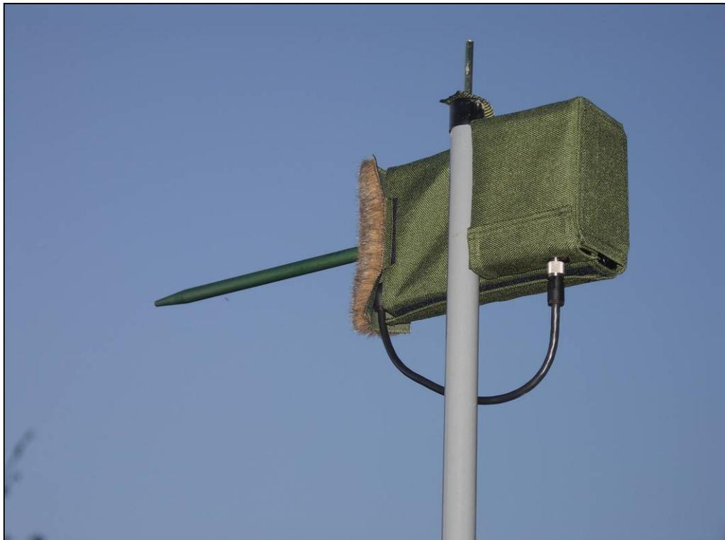
**Abb. 3** Automatische Registriereinheit („batcorder“, ecoObs, Nürnberg) zur Aufzeichnung und Speicherung von Fledermausrufen. Foto: G. Reiter
